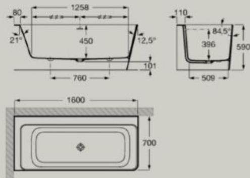
Banheira de canto assimétrico com painéis. Fabricada em Stonex®.
